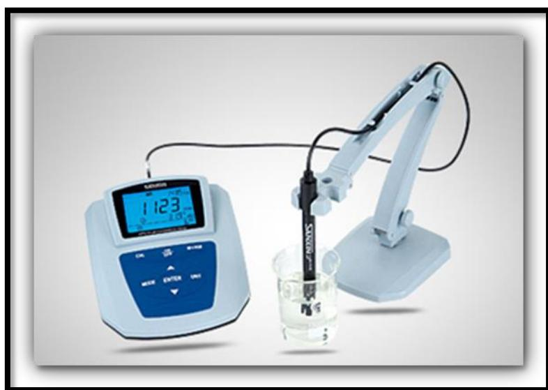
الشكل (11) جهاز قياس التوصيلية الكهربائية
