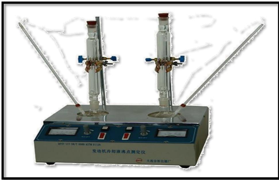
الشكل (2) جهاز تجديد قياس درجة الغليان السوائل
