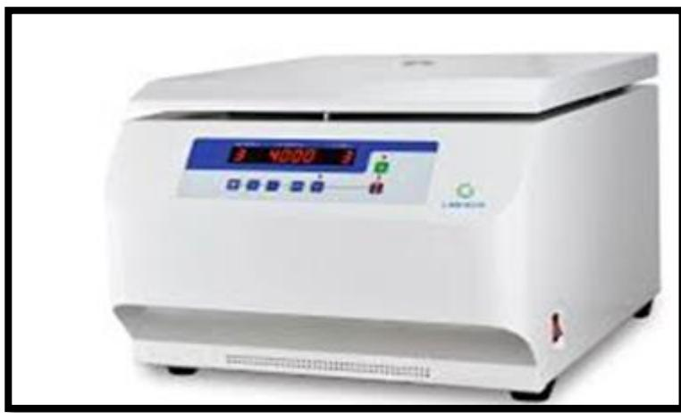
الشكل (14) جهاز الطرد المركزي
