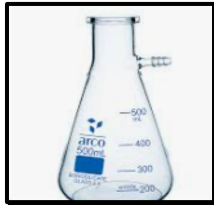
الشكل ( 40 ) دورق التفريغ
