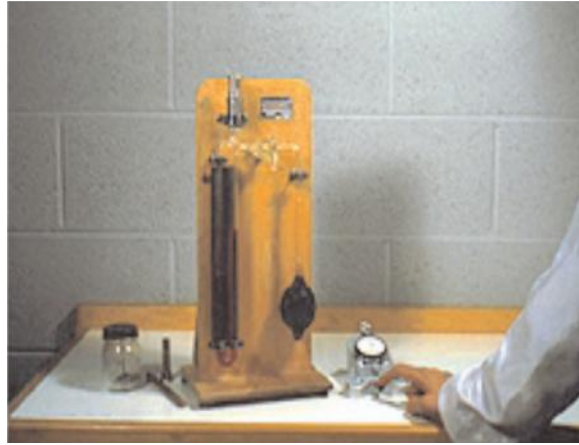
الشكل ( 8.2 ) جهاز بلين (Blaine) لقياس نعومة الإسمنت 2.6
