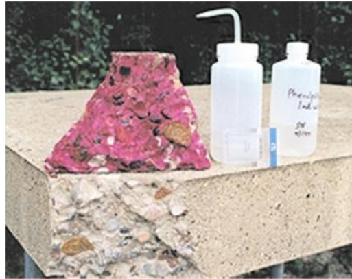
الشكل (5.12) اختبار عمق التوغل الكربوني في الخرسانة 2.6
