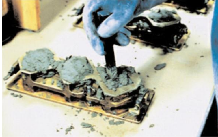
الشكل ( 10.2 ) القوالب المستخدمة في قياس مقاومة الإسمنت 2.6
