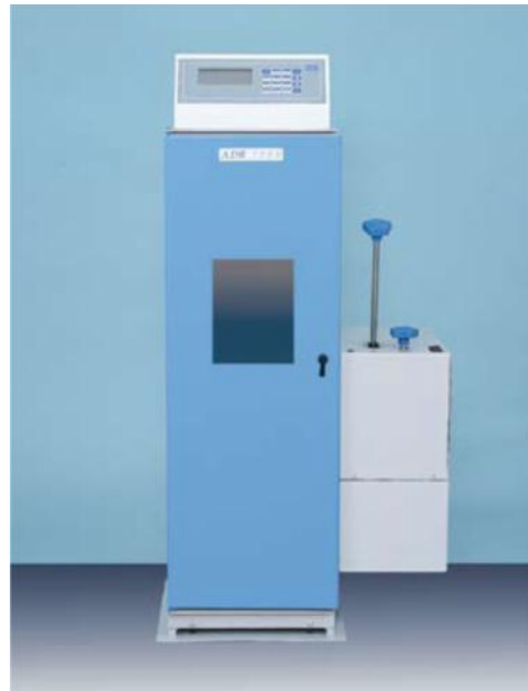
الشكل (3.11) ماكينة الضغط المباشر لتكسير العينات
