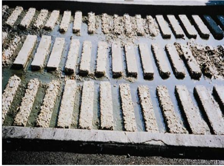
الشكل (10.12) كمرات خرسانية بعد 7 سنوات من غمرها في تربة غنية بالكلوريدات 2.6
