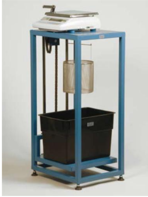
الشكل ( 2.3 ) الميزان الحساس لوزن العينة في الماء
