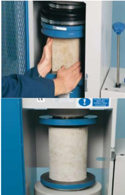
الشكل (3.11) ماكينة الضغط المباشر لتكسير العينات
