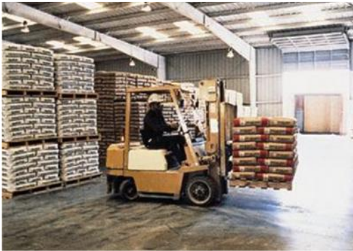
الشكل (1.7) طريقة تخزين الإسمنت
