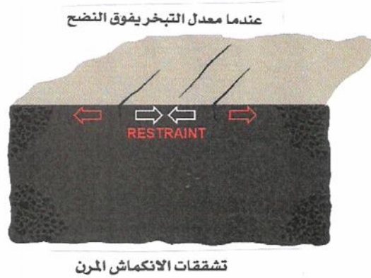
الشكل (6.9) كيفية حدوث التشققات في الخرسانة بسبب الانكماش
